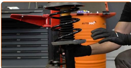
**44** Περάστε από επεξεργασία τις βάσεις στερέωσης του γόνατου του αμορτισέρ. Χρησιμοποιήστε μια συρματόβουρτσα. Χρησιμοποιήστε σπρέι WD-40.
