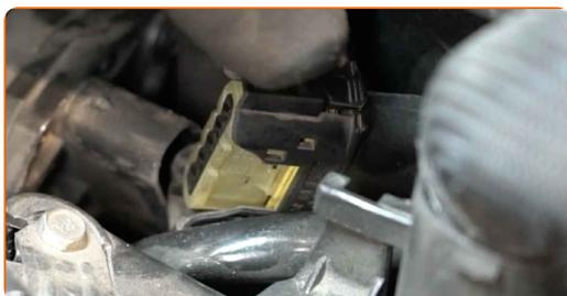
**8** Βγάλτε τα κλιπ συγκράτησης του αισθητήρα ροής μάζας αέρα. Χρησιμοποιήστε ένα λοστό.
