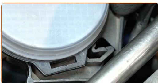
**16** Επεξεργαστείτε τη φίσσα του αισθητήρα ροής μάζας αέρα. Χρησιμοποιήστε μονωτικό γράσο.
