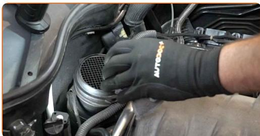
**12** Βγάλτε τα κλιπ συγκράτησης του αισθητήρα ροής μάζας αέρα. Χρησιμοποιήστε ένα λοστό.
