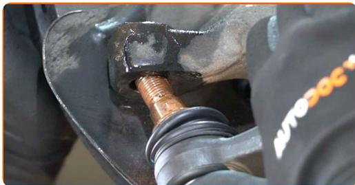
**15** Βιδώστε το παξιμάδι στερέωσης που συνδέει το ακρόμπαρο με το mouagié. Χρησιμοποιήστε ένα καρυδάκι #21. Χρησιμοποιήστε μια καστάνια.
