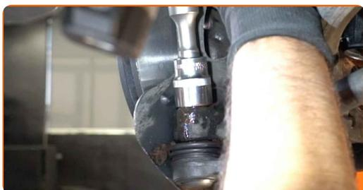
**16** Βιδώστε το μπαλάκι του ακρόμπαρου και το παξιμάδια ασφαλείας του ακρόμπαρου. Χρησιμοποιήστε ένα γερμανοπολύγωνο #21 (2 τεμάχια).
