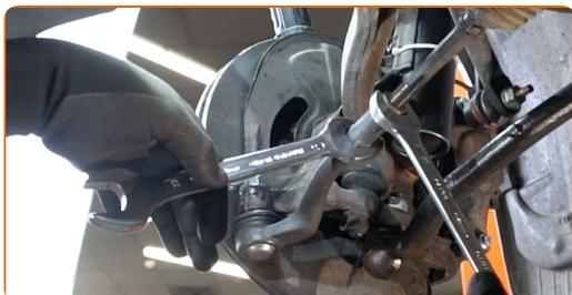
**17** Κατά την αποσύνδεση, σημειώστε ή μετρήστε την ακριβή θέση του μπαλακιού στο ακρόμπαρο, ή μετρήστε τον αριθμό περιστροφών κατά το ξεβίδωμα, για να αποφύγετε τη λανθασμένη ευθυγράμμιση στο τέλος της εργασίας. Χρησιμοποιήστε ένα παχύμετρο.
