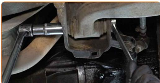
**18** Ξεβιδώστε τα στοιχεία στερέωσης που συνδέουν τον σφαιρικό (μπαλάκι) σύνδεσμο με το ακραξόνιο. Χρησιμοποιήστε ένα γερμανοπολύγωνο #19. Χρησιμοποιήστε ένα καρυδάκι #19. Χρησιμοποιήστε μια καστάνια.
