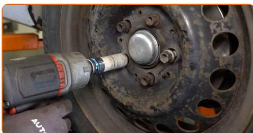
**50** Χαμηλώστε το αυτοκίνητο και χρησιμοποιήστε σταυρό, προκειμένου να σφίξετε τα μπουλόνια των τροχών. Χρησιμοποιήστε κρουστικό καρυδάκι για μπουλονόκλειδο Νο #17. Χρησιμοποιήστε ένα δυναμόκλειδο. Σφίξτε τη με ροπή 110 Nm.
