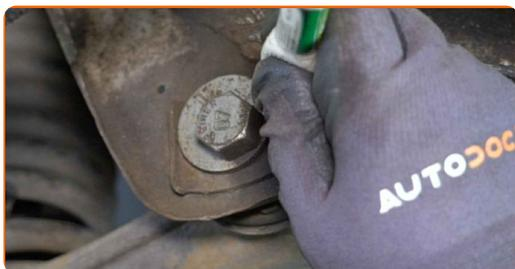
**16** Ξεβιδώστε το μπροστινό στοιχείο στερέωσης του βραχίονα ελέγχου (ψαλιδιού). Χρησιμοποιήστε ένα γερμανοπολύγωνο #22. Χρησιμοποιήστε ένα καρυδάκι #22. Χρησιμοποιήστε μια καστάνια.
