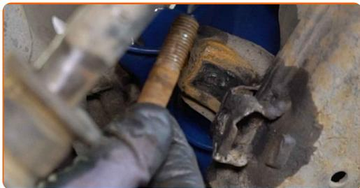
**20** Αφαιρέστε τον σφαιρικό σύνδεσμο από το ακραξόνιο. Χρησιμοποιήστε ένα ίσιο σκαρπέλο μετάλλου. Χρησιμοποιήστε ένα σφυρί. Χρησιμοποιήστε ένα λοστό.
