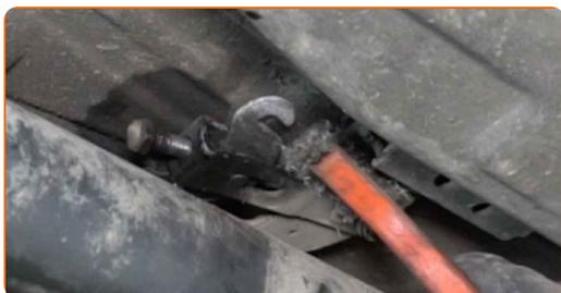
**36** Τοποθετήστε μία καινούρια ντίζα χειρόφρενου. Χρησιμοποιήστε ένα σφυρί.
