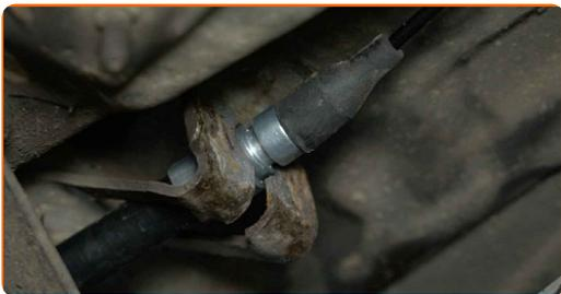
**37** Τοποθετήστε την ασφάλεια συγκράτησης που συνδέει τη ντίζα του χειρόφρενου με το αμάξιωμα του αυτοκινήτου.
