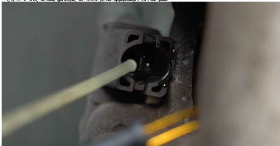
24 Συνδέστε το βύσμα του αισθητήρα φθοράς τακακίων φρένων.
