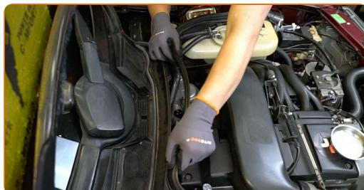
4 Αφαιρέστε το κεντρικό τμήμα που συγκρατεί τη στεγανοποίηση του τροπέτου των υαλοκαθαριστήρων.
