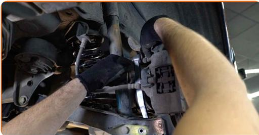
**13** Ευθυγραμμίστε τις οπές στις στοιχείων στερέωσης στο μπαράκι της αντιστρεπτικής δοκού και το βραχίονα ελέγχου της ανάρτησης. Χρησιμοποιήστε ένα ζουμπά. Χρησιμοποιήστε μια λαστιχένια ματσόλα.
