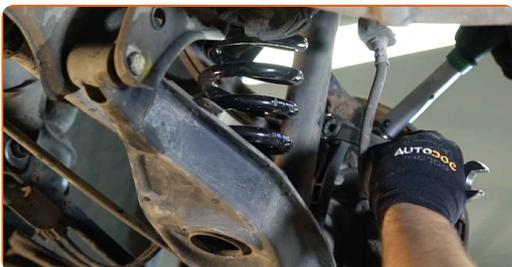
**15** Σφίξτε το στοιχείο στερέωσης στο μπαράκι της αντιστρεπτικής δοκού. Χρησιμοποιήστε ένα γερμανοπολύγωνο #17. Χρησιμοποιήστε ένα γερμανοπολύγωνο #19. Χρησιμοποιήστε ένα καρυδάκι #17. Χρησιμοποιήστε ένα δυναμόκλειδο. Σφίξτε τη με ροπή 35 Nm.
