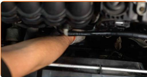
**9** Βιδώστε νέα μπουζί και σφίξτε τα. Χρησιμοποιήστε ένα καρυδάκι για μπουζόκλειδο #16. Χρησιμοποιήστε ένα δυναμόκλειδο. Σφίξτε τη με ροπή 27 Nm.
