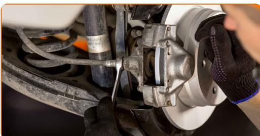
**13** Καθαρίστε τα στοιχεία στερέωσης της δαγκάνας των φρένων. Χρησιμοποιήστε μια συρματόβουρτσα. Χρησιμοποιήστε σπρέι WD-40.
