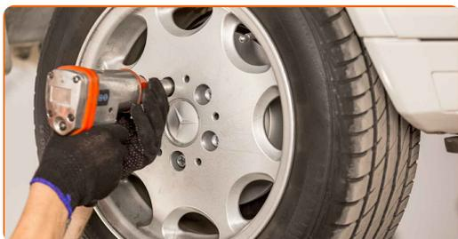
**35** Χαμηλώστε το αυτοκίνητο και χρησιμοποιήστε σταυρό, προκειμένου να σφίξετε τα μπουλόνια των τροχών. Χρησιμοποιήστε κρουστικό καρυδάκι για μπουλονόκλειδο Νο #17. Χρησιμοποιήστε ένα δυναμόκλειδο. Σφίξτε τη με ροπή 110 Nm.
