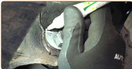
**10** Ξεβιδώστε το πίσω στοιχείο στερέωσης του βραχίονα ελέγχου. Χρησιμοποιήστε ένα γερμανοπολύγωνο #22. Χρησιμοποιήστε ένα καρυδάκι #22. Χρησιμοποιήστε μια καστάνια.
