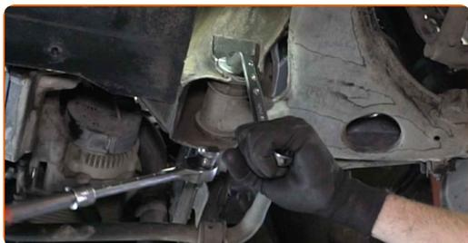
**12** Ξεβιδώστε τα στοιχεία στερέωσης που συνδέουν το στήριγμα της αντιστρεπτικής δοκού με το ψαλίδι. Χρησιμοποιήστε ένα καρυδάκι #13. Χρησιμοποιήστε μια καστάνια.
