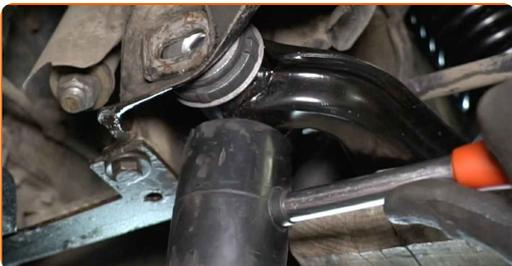
**27** Τοποθετήστε τις βίδες στερέωσης. Χρησιμοποιήστε μια λαστιχένια ματσόλα.
