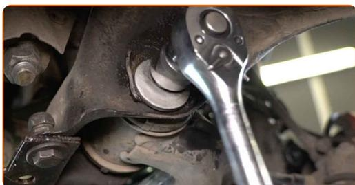
**11** Ξεβιδώστε το μπροστινό στοιχείο στερέωσης του βραχίονα ελέγχου (ψαλιδιού). Χρησιμοποιήστε ένα γερμανοπολύγωνο #22. Χρησιμοποιήστε ένα καρυδάκι #22. Χρησιμοποιήστε μια καστάνια.
