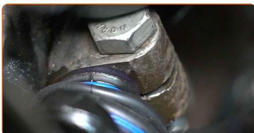
**24** Στηρίξτε τον βραχίονα ελέγχου (ψαλίδι). Χρησιμοποιήστε ένα υδραυλικό γρύλο σασμάν.
