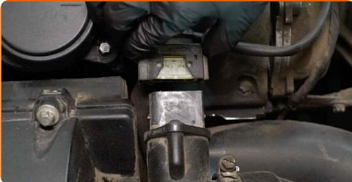
**4** Χαλαρώστε το σφιγκτήρα στερέωσης που συνδέει τον αγωγό της εισαγωγής αέρα με το περίβλημα του φίλτρου αέρα. Χρησιμοποιήστε ένα καρυδάκι #7. Χρησιμοποιήστε μια καστίνα.
