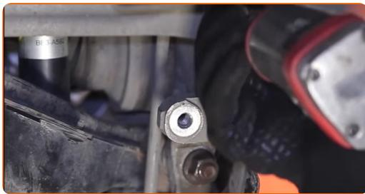
**23** Καθαρίστε τα στοιχεία στερέωσης των μπαρακιών της αντιστρεπτικής δοκού. Χρησιμοποιήστε μια συρματόβουρτσα. Χρησιμοποιήστε σπρέι WD-40.
