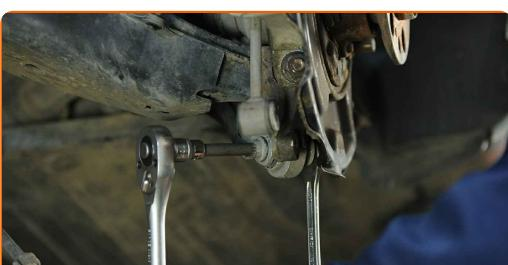
**28** Αφαιρέστε τη βίδα στερέωσης. Χρησιμοποιήστε ένα Τορξ M12. Χρησιμοποιήστε μια καστάνια.
