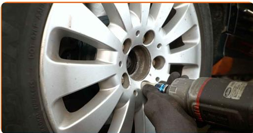
**38** Χαμηλώστε το αυτοκίνητο και χρησιμοποιήστε σταυρό, προκειμένου να σφίξετε τα μπουλόνια των τροχών. Χρησιμοποιήστε κρουστικό καρυδάκι για μπουλονόκλειδο No #17. Χρησιμοποιήστε ένα δυναμόκλειδο. Σφίξτε τη με ροπή 130 Nm.
