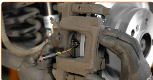
**25** Σφίξτε τα στοιχεία στερέωσης της δαγκάνας του φρένου. Χρησιμοποιήστε ένα Άλεν No.H7. Χρησιμοποιήστε ένα δυναμόκλειδο. Σφίξτε τη με ροπή 25 Nm.
