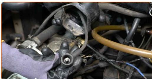
**17** Αφαιρέστε το μπουζοκαλώδιο από το καπάκι του πολλαπλασιαστή. Χρησιμοποιήστε ένα λοστό.
