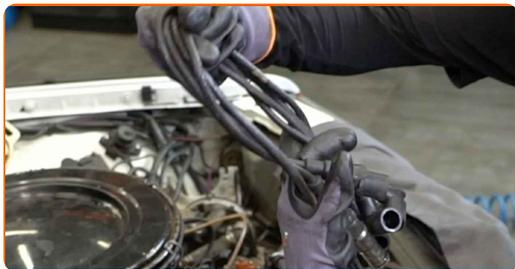
**12** Επεξεργαστείτε με προϊόν τους ακροδέκτες του διανομέα ανάφλεξης. Χρησιμοποιήστε μια συρματόβουρτσα. Χρησιμοποιήστε μονωτικό γράσο.
