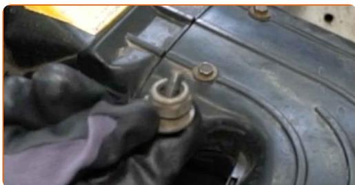
**6** Αφαιρέστε τον σωλήνα εισαγωγής.
