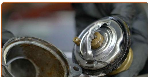
**23** Καθαρίστε τη βάση τοποθέτησης του θερμοστάτη. Χρησιμοποιήστε μια συρματόβουρτσα. Χρησιμοποιήστε ένα σπρέι καθαρισμού γενικής χρήσης.
