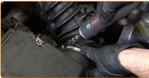
**4** Αφαιρέστε τον σωλήνα εισαγωγής αέρα.
