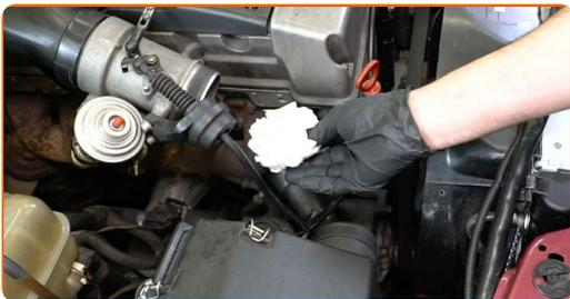
**38** Τοποθετήστε τον σωλήνα εισαγωγής αέρα και ασφαλίστε τον.
