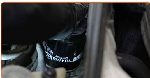
**16** Σφίξτε το φίλτρο λαδιού. Θυμηθείτε να τηρήσετε τη συνιστώμενη ροπή σύσφιξης. Χρησιμοποιήστε ένα καρυδάκι 76/14F. Χρησιμοποιήστε ένα δυναμόκλειδο. Σφίξτε τη με ροπή 20 Nm.
