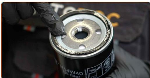
**15** Τοποθετήστε ένα καινούριο φίλτρο λαδιού.
