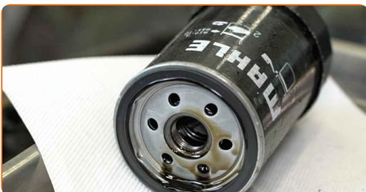
**13** Καθαρίστε το σημείο τοποθέτησης το φίλτρου λαδιού. Χρησιμοποιήστε ένα σπρέι καθαρισμού γενικής χρήσης.
