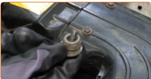
**6** Αφαιρέστε τον σωλήνα εισαγωγής.
