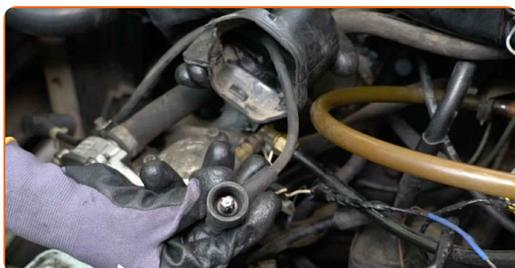
**9** Ξεβιδώστε τα στοιχεία στερέωσης των ακροδεκτών του πολλαπλασιαστή. Χρησιμοποιήστε ένα καρυδάκι #10. Χρησιμοποιήστε μια καστίνα.
