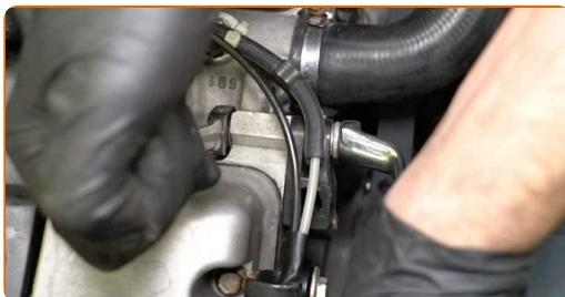
4 Χρησιμοποιήστε έναν μοχλό με την κατάλληλη διάμετρο, για να χαλαρώσετε τον τεντωτήρα και να αφαιρέσετε το μπουλόνι στερέωσης. Χρησιμοποιήστε προέκταση για καρυδάκι τετράγωνης κεφαλής 3/8".
