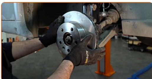
**21** Σφίξτε τις βίδες του δίσκου των φρένων. Χρησιμοποιήστε ένα σταυροκατσάβιδο. Χρησιμοποιήστε ένα δυναμόκλειδο. Σφίξτε τη με ροπή 9 Nm.
