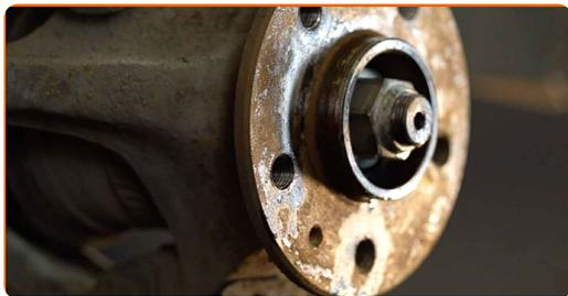
**19** Καθαρίστε την πλήμνη. Χρησιμοποιήστε μια συρματόβουρτσα. Καθαρίστε το σημείο επαφής. Χρησιμοποιήστε γράσο χαλκού.
