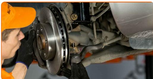
**16** Σφίξτε το παξιμάδι στερέωσης που συνδέει το μπαλάκι του ακρόμπαρου με το μουαγιέ. Χρησιμοποιήστε ένα καρνδάκι #21. Χρησιμοποιήστε ένα δυναμόκλειδο. Σφίξτε τη με ροπή 50 Nm.+60°
