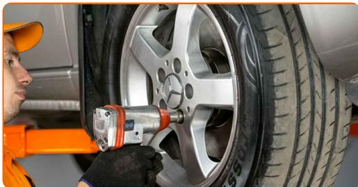
**23** Χαμηλώστε το αυτοκίνητο και χρησιμοποιήστε σταυρό, προκειμένου να σφίξετε τα μπουλόνια των τροχών. Χρησιμοποιήστε κρουστικό καρυδάκι για μπουλονόκλειδο No #17. Χρησιμοποιήστε ένα δυναμόκλειδο. Σφίξτε τη με ροπή 130 Nm.
