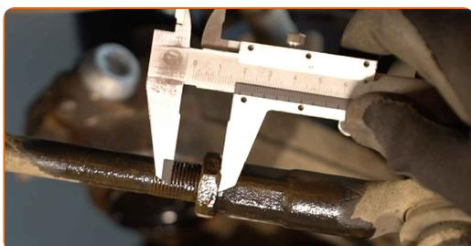
**7** Καθαρίστε το περικόχλιο ασφάλισης που συνδέει τη μπάρα διεύθυνσης με το ακρόμπαρο διεύθυνσης. Χρησιμοποιήστε μια συρματοβουρτσα. Χρησιμοποιήστε σπρέι WD-40.
