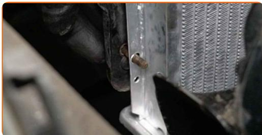
**28** Βιδώστε τα στοιχεία στερέωσης του περιβλήματος του βεντιλατέρ. Χρησιμοποιήστε ένα γερμανοπολύγυνο #10. Χρησιμοποιήστε ένα καρυδάκι #10. Χρησιμοποιήστε μια καστάνια.
