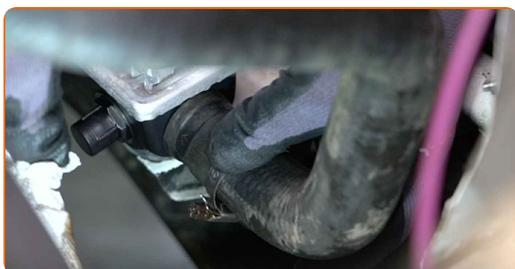
**30** Σφίξτε το σφιγκτήρα του κάτω σωλήνα ψυκτικού υγρού. Χρησιμοποιήστε ένα καρυδάκι #7. Χρησιμοποιήστε μια καστάνια.
