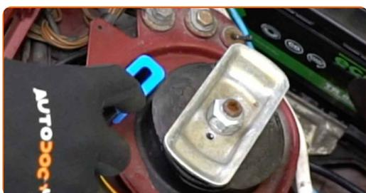
**4** Καθαρίστε το στοιχείο στερέωσης τη ράβδου του αμορτισέρ. Χρησιμοποιήστε μια συρματόβουρτσα. Χρησιμοποιήστε σπρέι WD-40.
