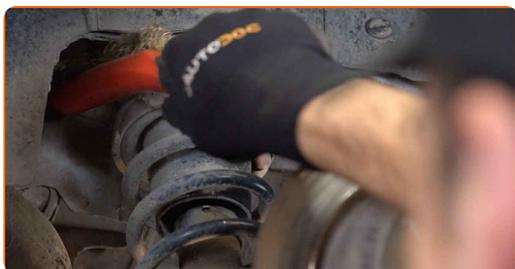
**7** Ξεβιδώστε το κάτω παξιμάδι του γόνατου του αμορτισέρ. Χρησιμοποιήστε ένα καρυδάκι #21. Χρησιμοποιήστε μια κασάνια. Χρησιμοποιήστε μια μανέλα κολαούζου.
