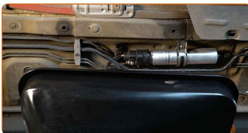
3 Αφαιρέστε την ασφάλεια του δακτύλου συγκράτησης του ρυθμιστή πίεσης καυσίμου. Χρησιμοποιήστε ένα ίσιο κατσαβίδι.
