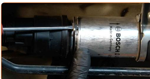
4 Χαλαρώστε το σφιγκτήρα στερέωσης της σωλήνας του φίλτρου καυσίμου. Χρησιμοποιήστε ένα ίσιο κατσαβίδι.
