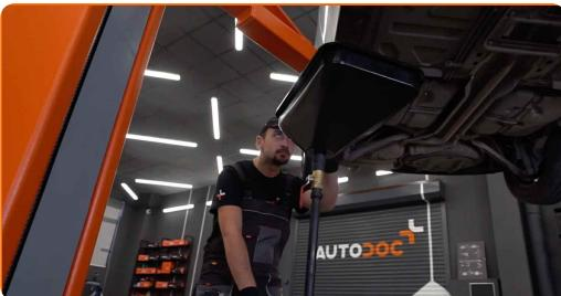
10 Ξεβιδώστε την τάπα αποστράγγισης. Χρησιμοποιήστε ένα καρυδάκι #13. Χρησιμοποιήστε μια καστάνια.
