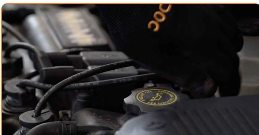
**3** Ξεβιδώστε το καπάκι του καλύμματος του φίλτρου μαζί με το παλιό στοιχείο φιλτραρίσματος. Χρησιμοποιήστε ένα καρυδάκι 76-14F. Χρησιμοποιήστε μια καστάνια.
