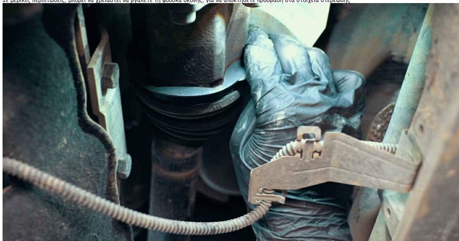
9 Σε μερικές περιπτώσεις, μπορεί να χρειαστεί να βγάλετε τη φούσκα σκόνης, για να αποκτήσετε πρόσβαση στα στοιχεία στερέωσης
