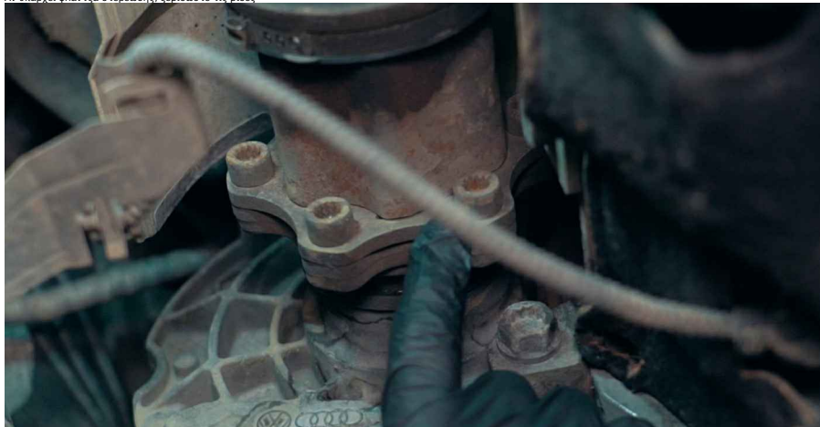
8 Αν υπάρχει φλάντζα στερέωσης, ξεβιδώστε τις βίδες
