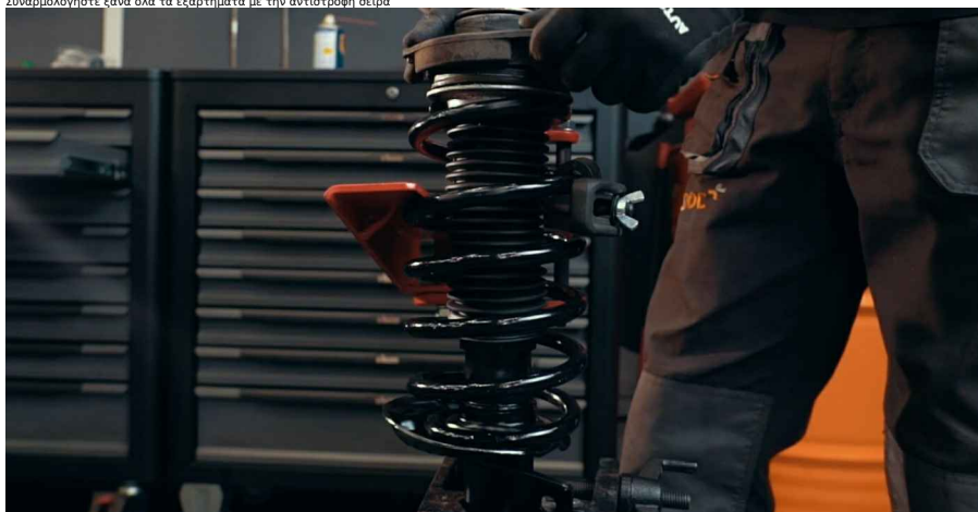
Σημαντικό! • Δώστε προσοχή στη θέση της βάσης γονάτου, για να βεβαιωθείτε ότι είναι στραμμένη προς τη σωστή κατεύθυνση
