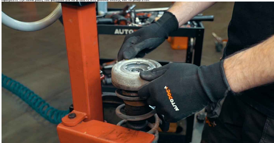
Παρακαλούμε, να θυμάστε! • Το μπαμ στοπ μπορεί να τοποθετηθεί στη ράβδο του εμβόλου ή να στερεωθεί στη βάση • Η φούσκα σκόνης μπορεί να τοποθετηθεί στο μπαμ στοπ, να εγκατασταθεί μεταξύ του ελατηρίου και βάσης ή να στερεωθεί στη βάση
