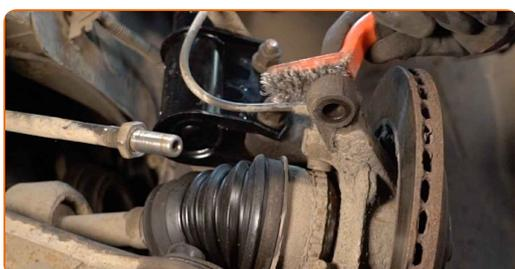
**15** Περάστε από επεξεργασία το τμήμα του ακρόμπαρου που διαθέτει σπείρωμα. Χρησιμοποιήστε γράσο χαλκού.
