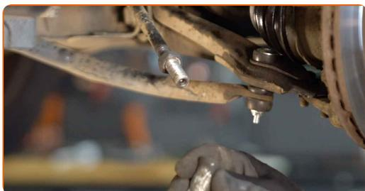
**14** Καθαρίστε τις βάσεις τοποθέτησης του ακρόμπαρου. Χρησιμοποιήστε μια συρματόβουρτσα. Χρησιμοποιήστε σπρέι WD-40.
