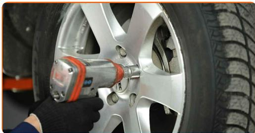
**25** Χαμηλώστε το αυτοκίνητο και χρησιμοποιήστε σταυρό, προκειμένου να σφίξετε τα μπουλόνια των τροχών. Χρησιμοποιήστε κρουστικό καρυδάκι για μπουλονόκλειδο No #21. Χρησιμοποιήστε ένα δυναμόκλειδο. Σφίξτε τη με ροπή 108 Nm.
