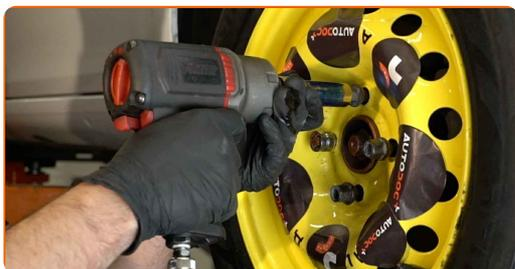
19 Χαμηλώστε το αυτοκίνητο και χρησιμοποιήστε σταυρό, προκειμένου να σφίξετε τα μπουλόνια των τροχών. Χρησιμοποιήστε κρουστικό καρυδάκι για μπουλονόκλειδο Νο #17. Χρησιμοποιήστε ένα δυναμόκλειδο. Σφίξτε τη με ροπή 105 Nm.
