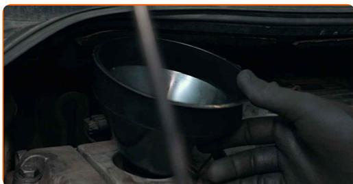
**20** Ρίξτε καινούριο λάδι στον κινητήρα στην ποσότητα που συνιστάται από τον κατασκευαστή του αυτοκινήτου.
