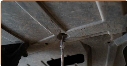
8 Αφαιρέστε το κάλυμμα του κάρτερ λαδιού. Χρησιμοποιήστε ένα καρυδάκι #10. Χρησιμοποιήστε ένα ίσιο κατσαβίδι.
