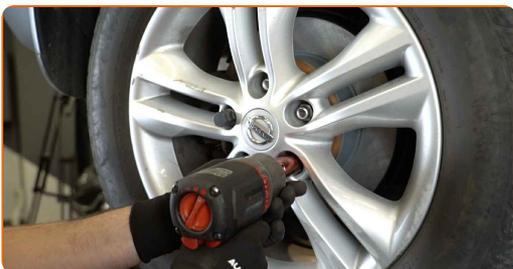
29 Χαμηλώστε το αυτοκίνητο και χρησιμοποιήστε σταυρό, προκειμένου να σφίξετε τα μπουλόνια των τροχών. Χρησιμοποιήστε κρουστικό καρυδάκι για μπουλονόκλειδο Νο #21. Χρησιμοποιήστε ένα δυναμόκλειδο. Σφίξτε τη με ροπή 112 Nm.
