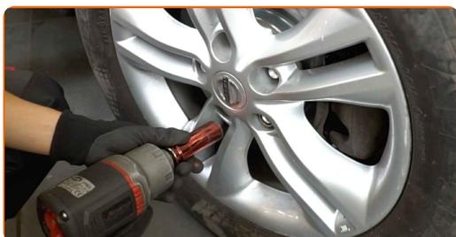
**24** Χαμηλώστε το αυτοκίνητο και χρησιμοποιήστε σταυρό, προκειμένου να σφίξετε τα μπουλόνια των τροχών. Χρησιμοποιήστε κρουστικό καρυδάκι για μπουλονόκλειδο No #21. Χρησιμοποιήστε ένα δυναμόκλειδο. Σφίξτε τη με ροπή 112 Nm.
