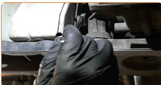
**22** Τοποθετήστε τη βάση συγκράτησης του φίλτρου καυσίμου.
