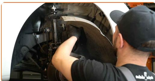
**9** Ξεβιδώστε τις βίδες στερέωσης της βάσης του φίλτρου καυσίμου. Χρησιμοποιήστε ένα καρυδάκι #13. Χρησιμοποιήστε μια καστάνια.
