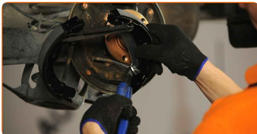
**20** Τοποθετήστε τις σιαγώνες στη θέση τους στο κυλινδράκι και στο αξονάκι στήριξής τους στο ταμπούρο.
