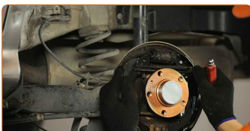
**21** Τοποθετήστε το κάτω ελατήριο επαναφοράς. Κάντε χρήση πένσας.
