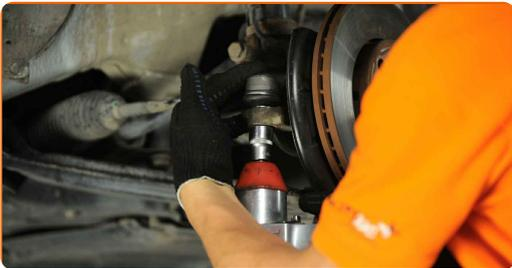
**17** Σφίξτε το παξιμάδι σύνδεσης του μπαλακιού με το ακρόμπαρο. Χρησιμοποιήστε ένα γερμανοπολύγωνο #21. Χρησιμοποιήστε ένα δυναμόκλειδο. Σφίξτε τη με ροπή 50 Nm.
