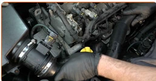
**17** Σφίξτε το κολάρο του σωλήνα εισαγωγής αέρα. Χρησιμοποιήστε ένα καρυδάκι #7. Χρησιμοποιήστε μια κασάνια.
