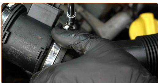
**18** Βιδώστε το στοιχείο στερέωσης της σωλήνας εισαγωγής αέρα. Χρησιμοποιήστε ένα Τορξ T25.
