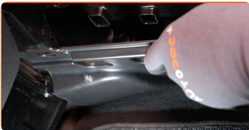
**9** Ξεβιδώστε τα στοιχεία στερέωσης του καλύμματος του περιβλήματος του φίλτρου καμπίνας. Χρησιμοποιήστε ένα καρυδάκι #5.5. Χρησιμοποιήστε μια καστίνα.
