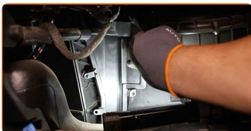
**14** Βιδώστε τα στοιχεία στερέωσης του καλύμματος του περιβλήματος του φίλτρου καμπίνας. Χρησιμοποιήστε ένα καρυδάκι #5.5. Χρησιμοποιήστε μια καστάνια.
