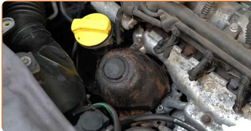
**29** Βιδώστε τα στοιχεία στερέωσης της προστατευτικής θήκης του περιβλήματος του φίλτρου λαδιού. Χρησιμοποιήστε ένα Τορξ T25. Χρησιμοποιήστε ένα καρυδάκι #10. Χρησιμοποιήστε μια καστάνια.
