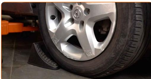
3 Ξεβιδώστε το στοιχείο στερέωσης που συνδέει τον άξονα κίνησης στην πλήμνη του τροχού. Χρησιμοποιήστε ένα καρυδάκι #32. Χρησιμοποιήστε μια μανέλα κολαούζου.
