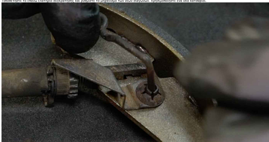
club.autodoc.gr 11-18 36 Εγκαταστήστε μια καινούρια δεξιά σιαγόνα φρένων.
