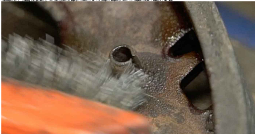
30 Βγάλτε το ανεμπλόκ. Χρησιμοποιήστε μια γκαζοτανάλια.
