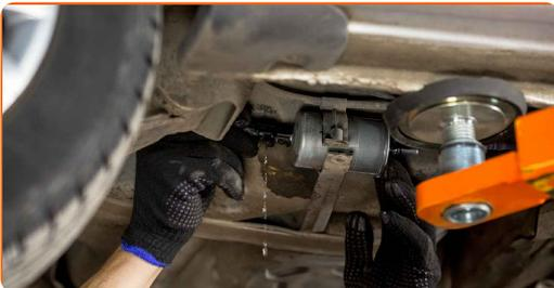
**7** Σφίξτε τα στοιχεία στερέωσης του φίλτρου καυσίμου. Χρησιμοποιήστε ένα σταυροκατσάβιδο.
