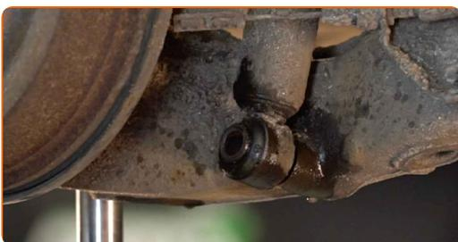
10 Ξεβιδώστε το επάνω παξιμάδι του αμορτισέρ. Χρησιμοποιήστε ένα καρυδάκι #E20. Χρησιμοποιήστε μια μανέλα κολαούζου.
