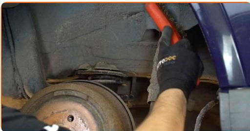
7 Στηρίξτε το ψαλίδι. Χρησιμοποιήστε ένα υδραυλικό γρύλο σασμάν.
