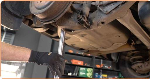
8 Ξεβιδώστε την κάτω βίδα του αμορτισέρ. Χρησιμοποιήστε ένα καρυδάκι #E20. Χρησιμοποιήστε μια μανέλα κολαούζου.
