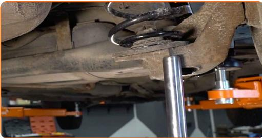
16 Σφίξτε την πάνω βίδα του αμορτισέρ. Χρησιμοποιήστε ένα καρυδάκι #E20. Χρησιμοποιήστε ένα δυναμόκλειδο. Σφίξτε τη με ροπή 90 Nm.
