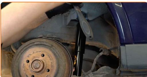
14 Βιδώστε το κάτω στοιχείο στερέωσης του αμορτισέρ. Χρησιμοποιήστε ένα καρυδάκι #E20.
