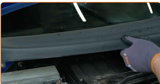
**9** Αφαιρέστε το πλαστικό κάλυμμα των υαλοκαθαριστήρων που βρίσκεται στη δεξιά πλευρά.
