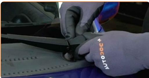
**2** Καθαρίστε τα στοιχεία στερέωσης των βραχιόνων υαλοκαθαριστήρων. Χρησιμοποιήστε μια συρματόβουρτσα. Χρησιμοποιήστε σπρέι WD-40.
