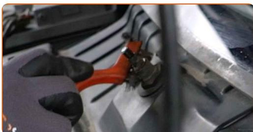
**12** Ξεβιδώστε τα στοιχεία στερέωσης των πλαστικών πάνελ. Χρησιμοποιήστε ένα γερμανοπολύγωνο #24.
