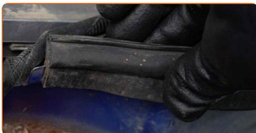
**11** Καθαρίστε τα στοιχεία στερέωσης των πλαστικών πάνελ. Χρησιμοποιήστε μια συρματόβουρτσα. Χρησιμοποιήστε σπρέι WD-40.
