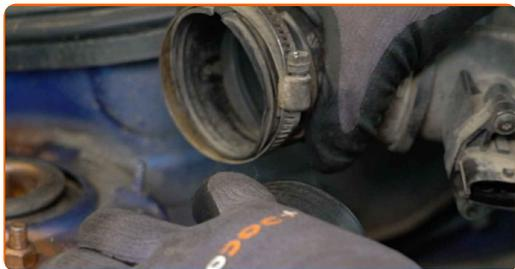
**6** Ξεβιδώστε τα κολάρα που ασφαλίζουν τον αισθητήρα μάζας αέρα στους σωλήνες αέρα. Χρησιμοποιήστε ένα ίσιο κατσαβίδι.
