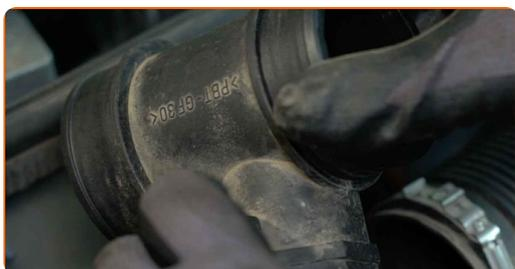
**8** Τοποθετήστε έναν καινούριο αισθητήρα ροής μάζας αέρα.
