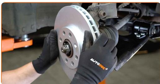
**21** Σφίξτε τις βίδες του δίσκου των φρένων. Χρησιμοποιήστε ένα Τορξ T30. Χρησιμοποιήστε ένα δυναμόκλειδο. Σφίξτε τη με ροπή 8 Nm.
