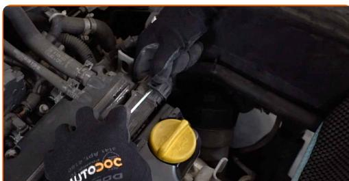
**4** Ξεβιδώστε το καπάκι του πολλαπλασιαστή. Χρησιμοποιήστε ένα Τορξ T30. Χρησιμοποιήστε μια καστάνια.
