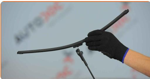
Αντικατάσταση: μάκτρο καθαριστήρα - OPEL Astra H GTC (A04).
